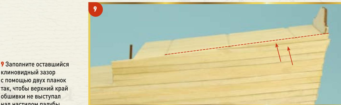
**9** Заполните оставшийся клиновидный зазор с помощью двух планок так, чтобы верхний край обшивки не выступал над настилом палубы.
