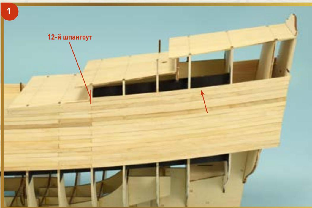
**1** Мы продолжаем работу над черновой обшивкой корпуса нашей модели. Отрежьте фрагмент планки нужной длины и, руководствуясь фотографией, приклейте его к кормовой части модели, начиная с двенадцатого шпангоута.
