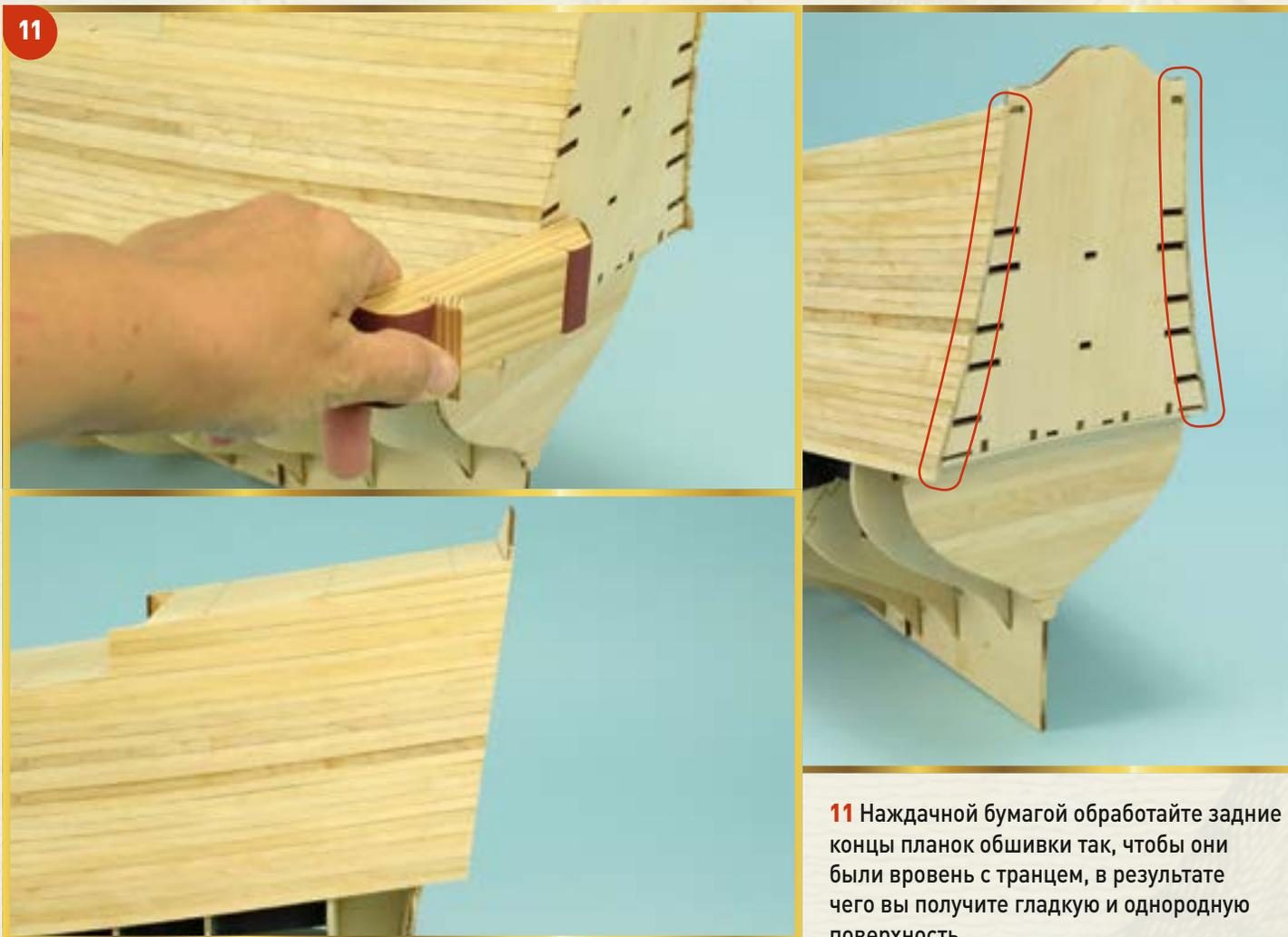
**11** Наждачной бумагой обработайте задние концы планок обшивки так, чтобы они были вровень с транцем, в результате чего вы получите гладкую и однородную поверхность.
